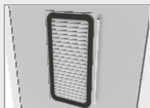
Остекление полотна с установкой жалюзи
